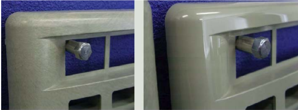
Figura 10. Pieza aditivada con fibra de vidrio, a la izquierda inyección convencional, a la derecha inyección con “H&C” [2].
