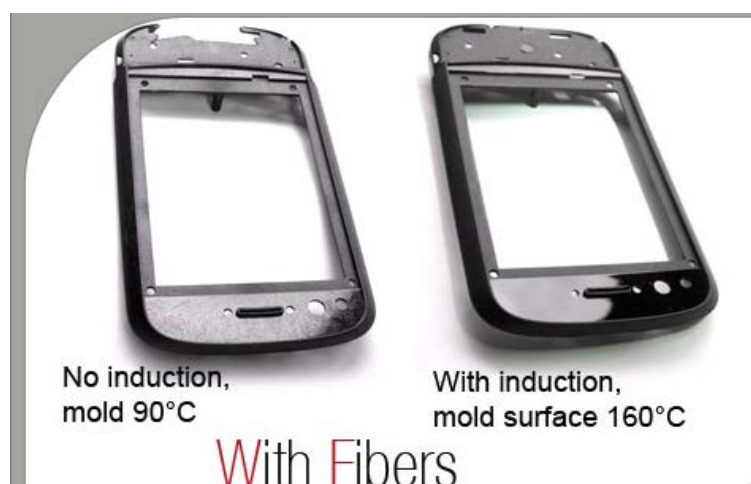
Figura 12. Piezas reforzadas con fibra mediante “H&C” y convencionales [3].
