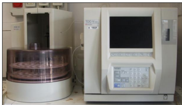
Figura I. Analizador de carbono orgánico total SHIMADZU, modelo TOC-V CSH
