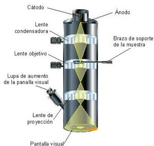
Figura 8. Esquema funcional del TEM
