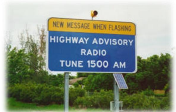
Figura 6. Señalización intermitente en carretera
