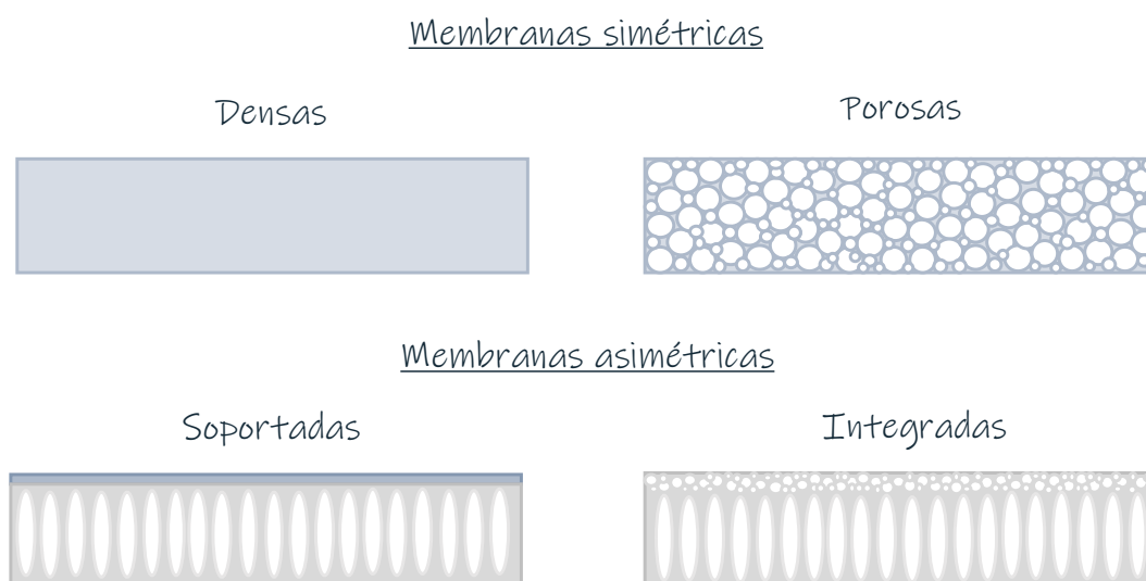
Figure 2.5. Representación esquemática de los tipos de membranas en función de su estructura microscópica.
