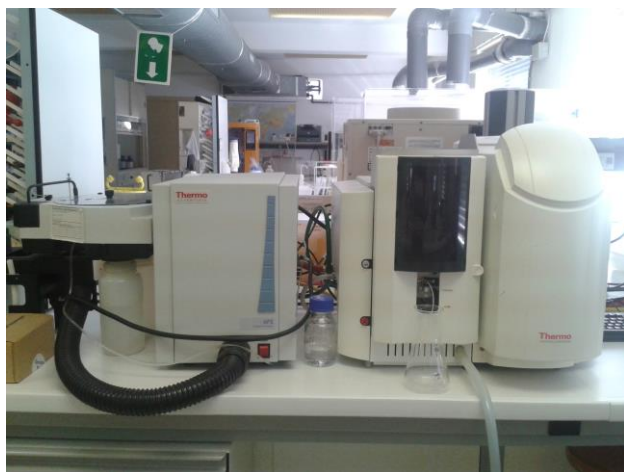
Figura 12. Equipo de absorción atómica
