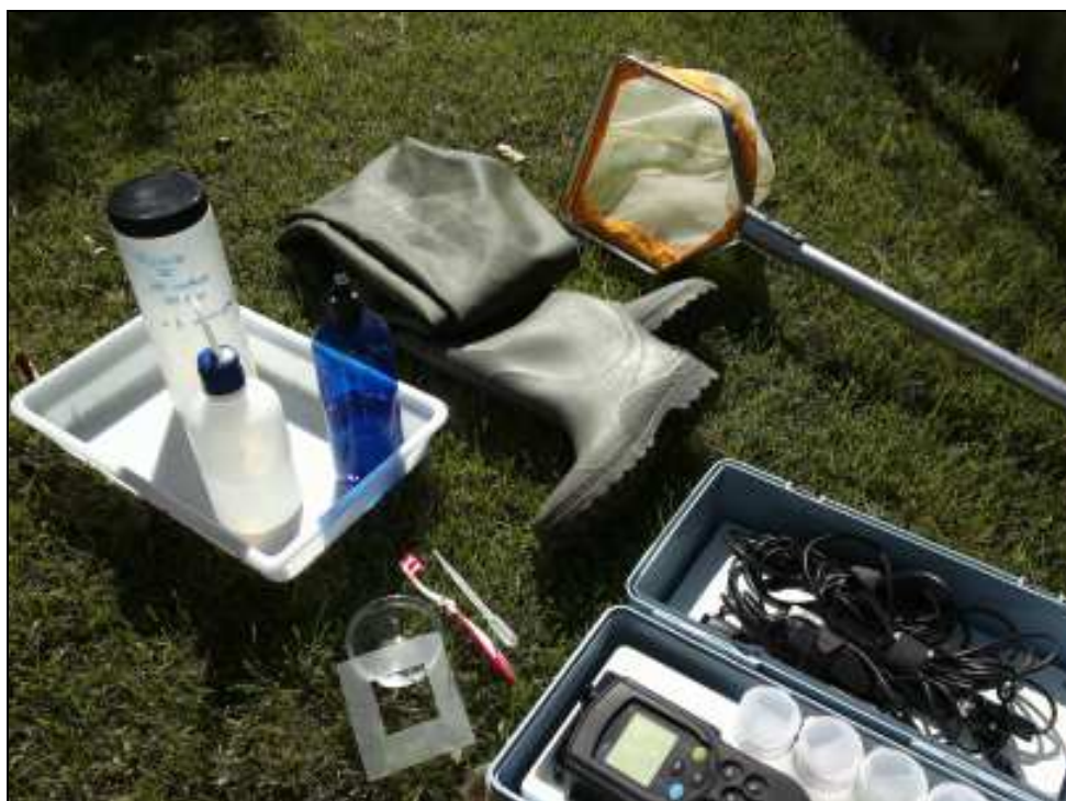
Figura 10: Arriba; bandeja, frasco de plástico, agua destilada, etanol (70 %), vadeador y red surber. Abajo; material para muestreo de perifiton: frasco de cristal, cepillo, pipeta y molde de plástico (5 x 5 cm). Derecha; sondas de pH, conductividad y \text{O}_2 disuelto.
