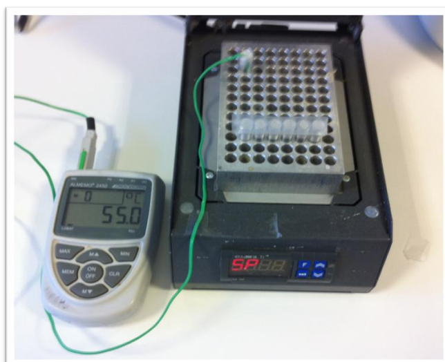
Figura 3.1: Imagen de la Incubadora FX de placas multipocillo empleada para la determinación de la termorresistencia
