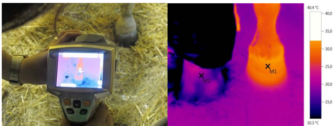
Figura 3: Izquierda: medición de la temperatura de superficie del casco con cámara termográfica. Derecha: imagen termográfica a los 195 minutos de colocar el dispositivo con hielos en la extremidad anterior derecha y la extremidad contralateral como control. Los puntos representados con M1 y M2 son los puntos referencia para el registro de la temperatura externa.
