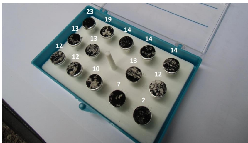
Figura 17. Muestras tomadas para analizar en el SEM-EDS. La numeración corresponde al arco en el que han sido tomadas, se observa como en los arcos centrales la cantidad de material adherido es mayor que en los laterales.
