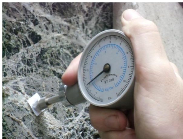
Figura 14. Penetrómetro adaptado para tomar muestras por arranque.
