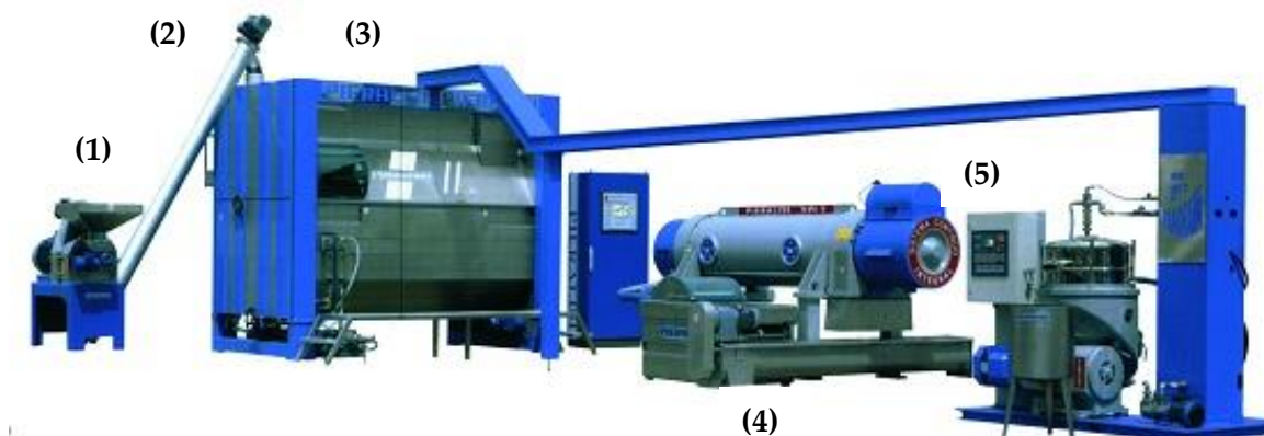
Figura 1.27. Sistema continuo de Pieralisi. Molino (1), elevador de pasta (2), batidora de dos cuerpos (3), decanter (4) y centrifuga vertical o decanter (5). Fuente: Pieralisi.
