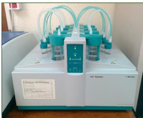
Figura 3.17. Equipo Rancimat 743 para la medida de la estabilidad oxidativa. Fuente: imagen propia.
