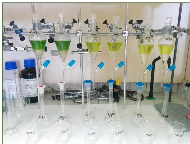
Figura 3.19. Extracción de la fracción fenólica polar del aceite de oliva virgen. Fuente: imagen propia.
