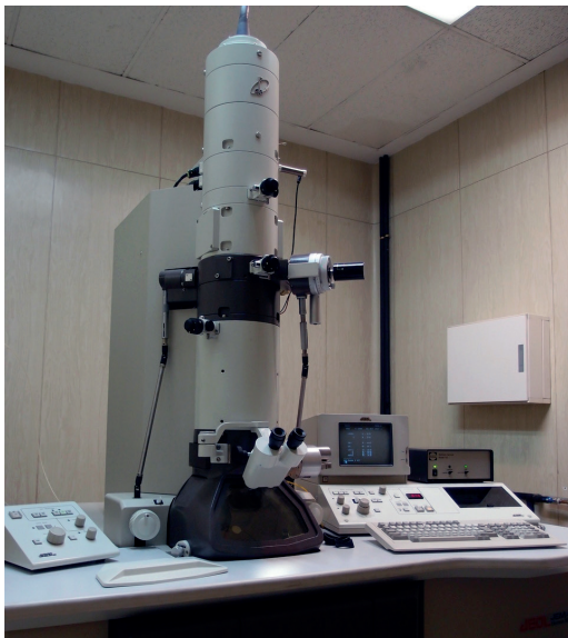
Figura 1. Microscopio electrónico de transmisión JEOL 1010. Servicio de Microscopía Electrónica de Sistemas Biológicos (SAI). Universidad de Zaragoza.
