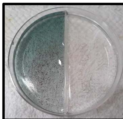
Figura N.1. Ejemplo de viraje en la titulación con tiosulfato.
