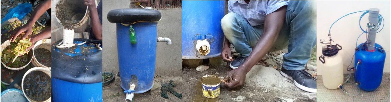
Figura 13. Biodigestor domestico en tambor de PVC, Haití (Cherenfant & Tech, 2022) y Prototipo experimental con sistema de sensorización (Regattieri et al., 2018)
