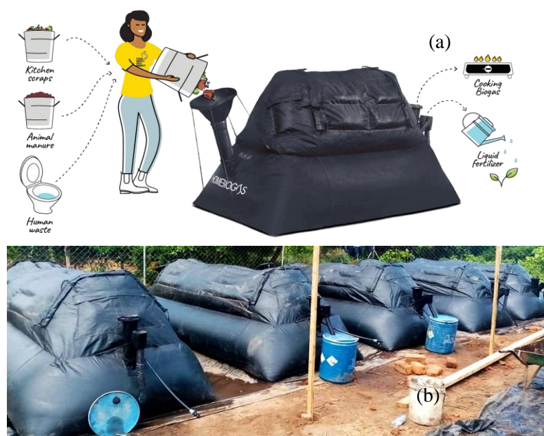
Figura 16. a) Funcionamiento biodigestor portátil HomeBiogas (HomeBiogas, 2023b), b) Sistema de producción de biogás en el campo de refugiados de Tongogara, Zimbabwe (Pinkerton, 2022)
