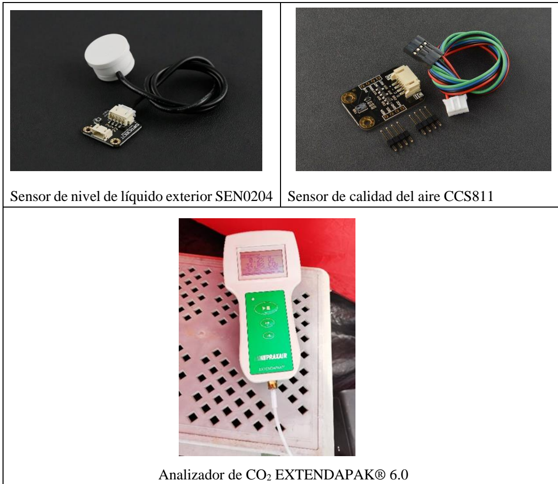
Figura 32. Sensores, microcontroladores y analizadores utilizados para el monitoreo y control del bioproceso de digestión anaerobia
