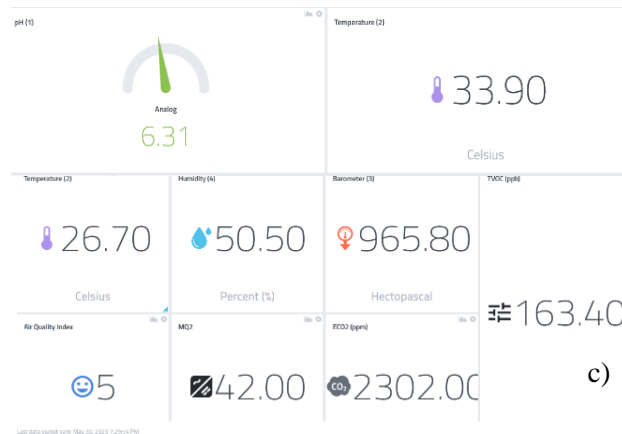
Figura 36. Evolución del pH y la temperatura (a) y el CO 2 (b) durante el proceso de digestión anaeróbica a escala de laboratorio y visualización de los parámetros entregados por los sensores en Cayenne (c)
