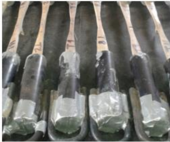
Figura 4. Muestras de tiras de caña guadua con una reducción de su área en el centro para el ensayo de tracción.
