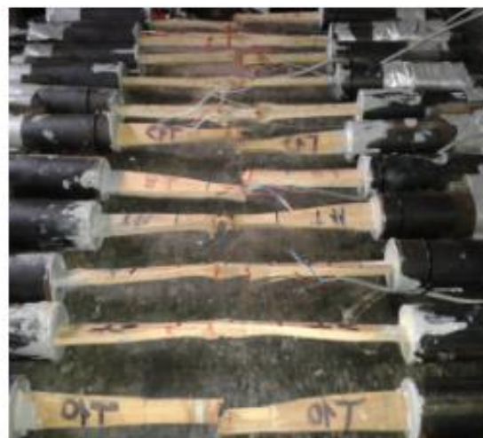
Figura 7. Mecanismo de falla de muestras de caña guadua a tracción.
