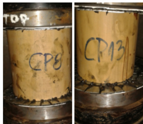
Figura 1. Ensayo de compresión simple paralela a la fibra. Fuente: Córdova, P. 2014. Obtención de las Propiedades mecánicas y estructurales de la caña guadua Angustifolia Kunth del Ecuador.
