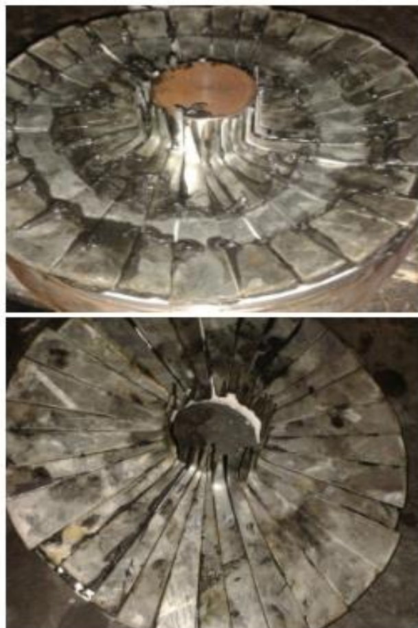
Figura 2. Placa elaborada para el ensayo de compresión libre de fricción en la muestra, que permite el deslizamiento horizontal.
