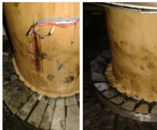
Figura 3. Muestras ensayadas a compresión simple. Fuente: Córdova, P. (2014). Obtención de las propiedades mecánicas y estructurales de la caña guadua Angustifolia Kunth del Ecuador
