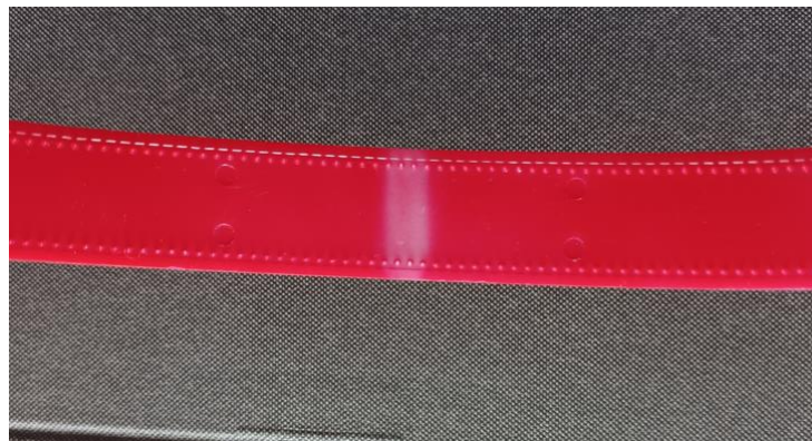
Ilustración 90. Diadema de plástico. Marca de esfuerzo. Propia autor
