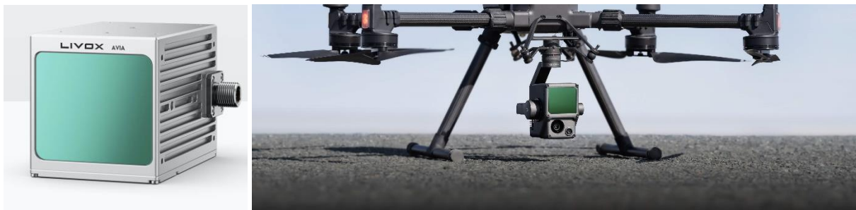
Figura 2. Sensor LIVOX AVIA (izq.) y UAV Matrice 300 rtk con Zenmuse L1 (der.) (Fuentes: Livox y DJI)
