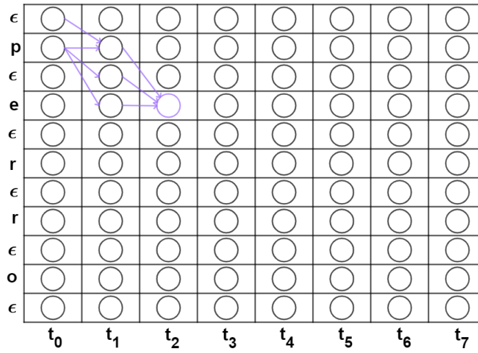
Figura 3.7: Ejemplo del cálculo de la probabilidad forward \alpha_{4,t_2} en el etiquetado \mathbf{z} = "perro".
