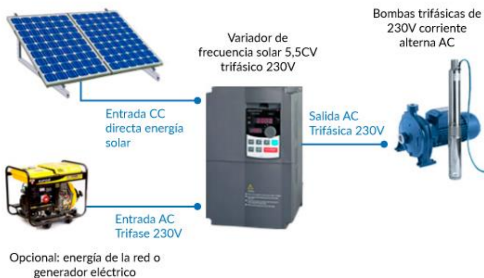
Figura 1-10. Conexión del VDF alimentado con módulos solares CC a controlar una bomba.
