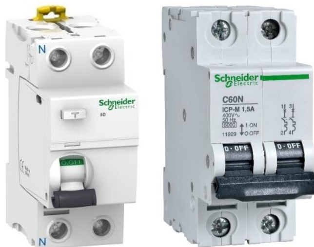
Figura 1-13. Diferencial Schneider 2P 30 mA AC 80 A AC (Izquierda) e Interruptor Automático Magnetotérmico Schneider 11935 2P, 15 A, 400 V (derecha).
