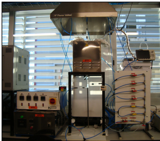
Figura 3.2. Instalación experimental para el estudio de la reactividad del hollín en diferentes atmósferas.
