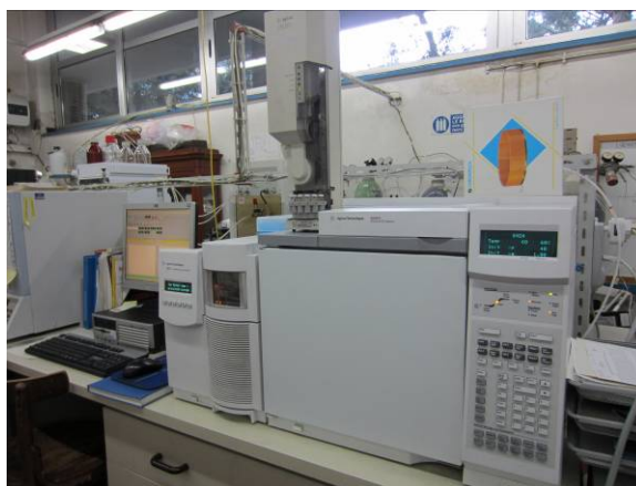
Figura 3.9. Cromatógrafo de gases HP6890, acoplado a un espectrómetro de masas HP5975.
