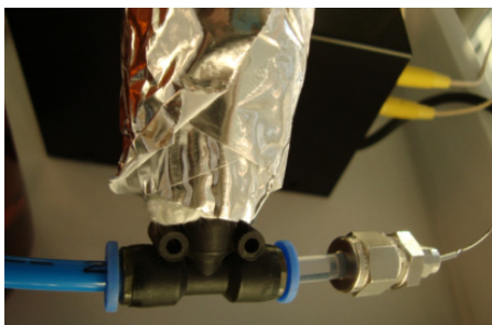
Figura 3.15. Conexiones: Línea de N 2 (izquierda), salida bomba isocrática (derecha), entrada al reactor (centro).
