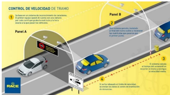
Ilustración 4 Esquema del funcionamiento del radar de tramo
