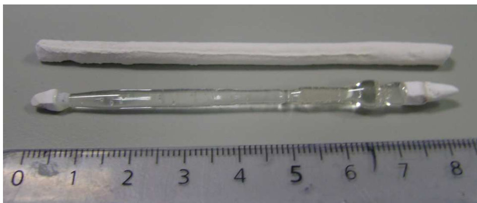
Figura 9. Precursor y vidrio obtenido con la técnica LFZ
