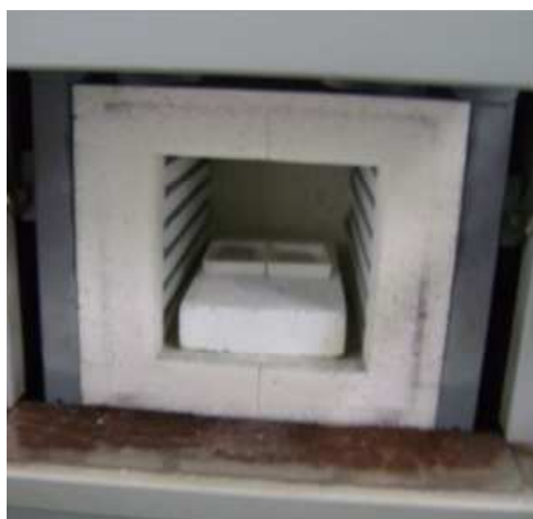
Figura 44. Horno utilizado para sinterizado
