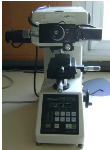
Figura 62. Microdurómetro Matsuzawa MX70 utilizado para la determinación de la microdureza y la tenacidad
