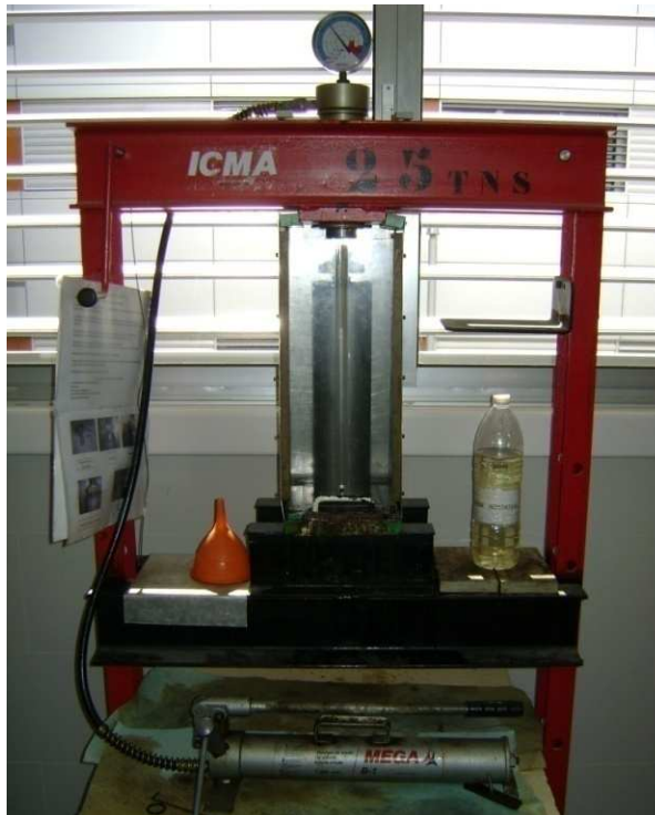
Figura 42. Prensa hidráulica de 25 Tn para realizar la compactación isostática
