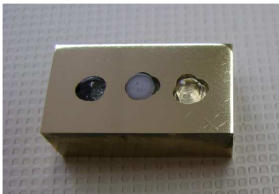
Figura 10. Portamuestras con las muestras embutidas para su observación en SEM
