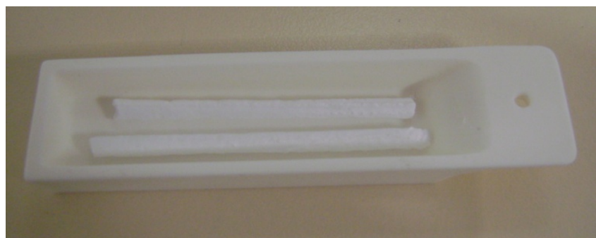
Figura 7. Precursores obtenidos mediante compactación isostática y sinterización
