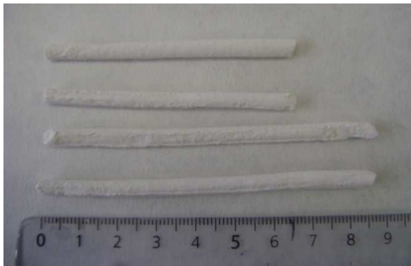
Figura 43. Precursores obtenidos tras el proceso de CIP
