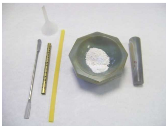
Figura 41. Elementos necesarios para el llenado del molde
