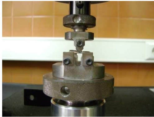
Figura 66. Esquema del ensayo de flexión por tres puntos
