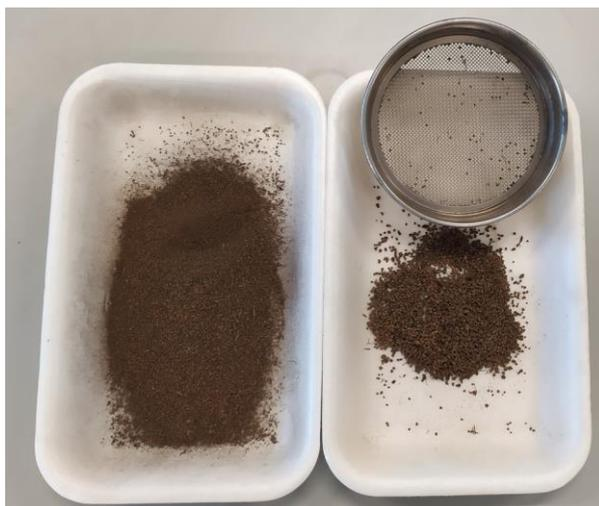
Figura 9. Tamizado de agregados de 1-2 mm de tamaño. Fuente: Ana P. Conte.
