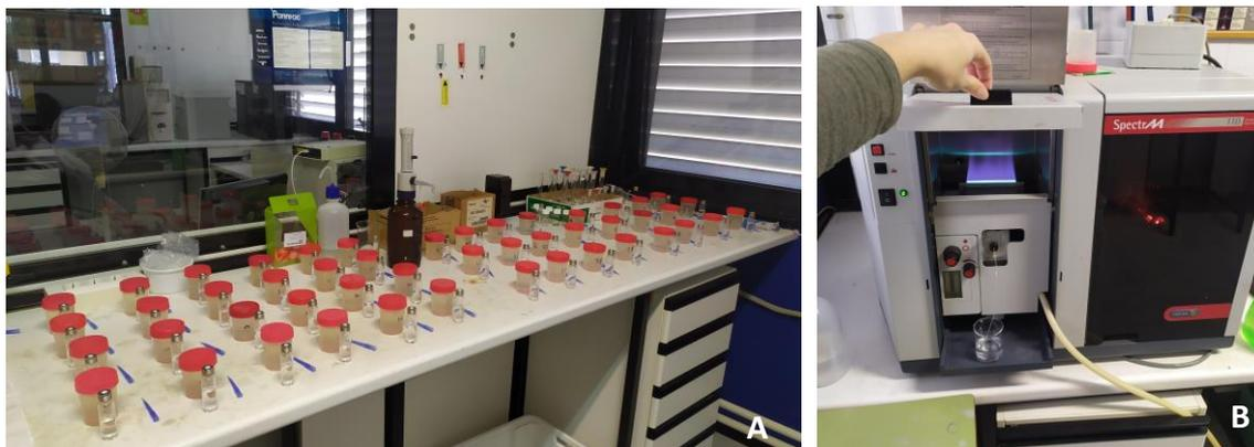
Figura 14. A y B. Extractos y diluciones (A) para analizar el  $\text{Ca}^{2+}$  y el  $\text{Mg}^{2+}$  mediante Espectroscopía de Absorción Atómica (B). Fuente: Ana Paula Conte.
