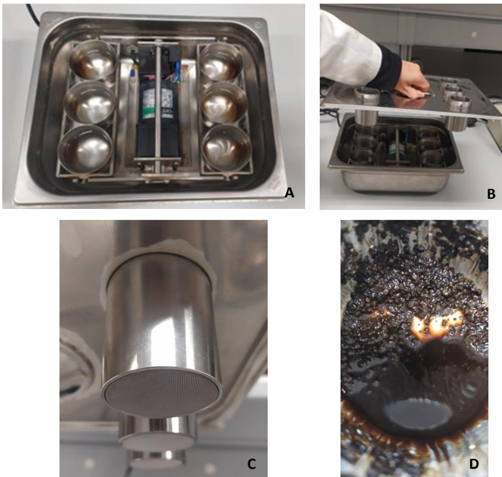
Figura 12. A, B, C y D. Tamizador eléctrico (A y B) con sus tamices específicos (C). Dispersión de los agregados estables por el efecto del pirofosfato sódico (D). Fuente: Ana P. Conte.
