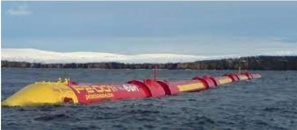
Imagen 5. Dispositivo Pelamis. Fuente: Google imágenes.
