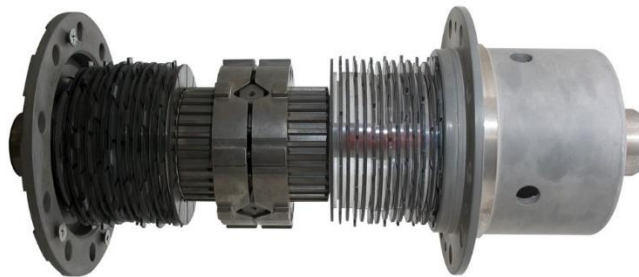
Figura 44. Diferencial Salisbury axle.
