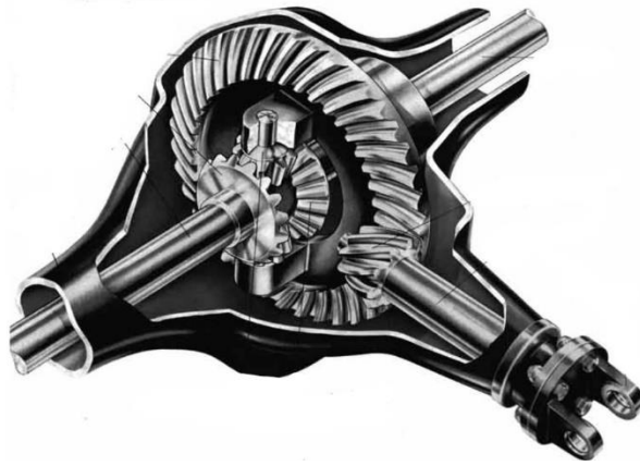
Figura 5. Diferencial abierto o básico.
