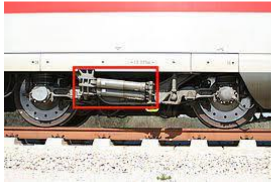
Ilustración 14 Amortiguador antilazo en un bogie ICE3
