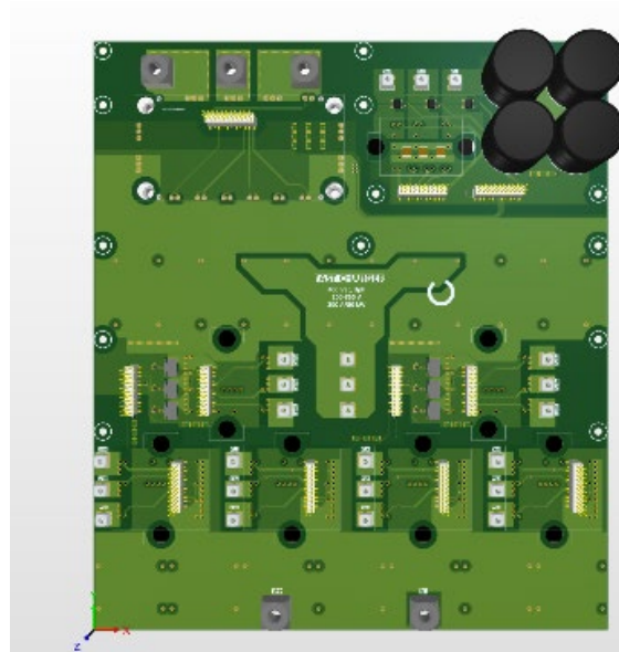
Figura 4.10: Vista Alzado de modelo 3D de la PCB inferior.
