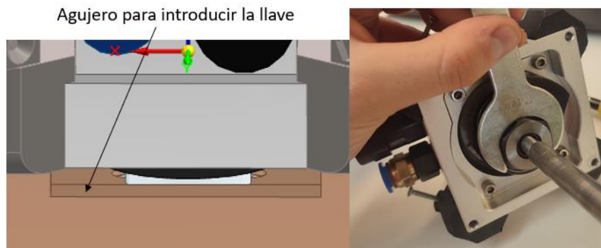
Figura 25 Agujero para introducir llave en el montaje del eje
