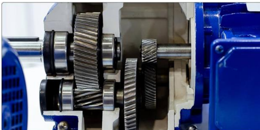
Figura 79. Disposición de engranajes y rodamientos en un reductor de 3 etapas con engranajes cilíndricos helicoidales.
