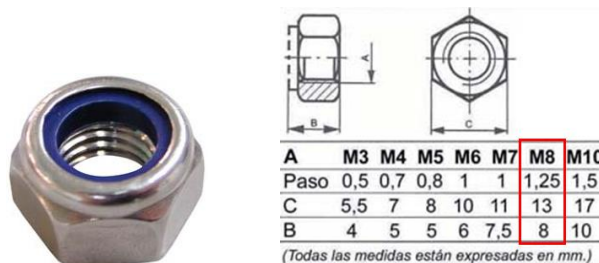
Figura 39. Tuercas autoblocantes DIN 985 y tabla de medidas.
