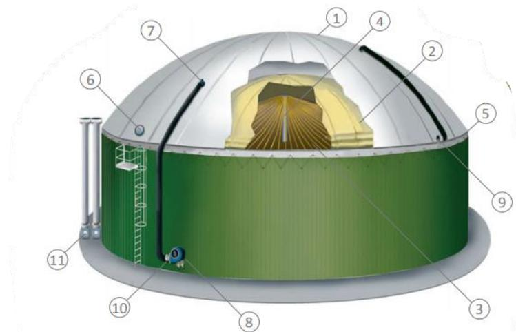
Ilustración 21. Esquema de gasómetro de doble membrana (Tecon textiles de construcción): 1 Membrana exterior. 2 Membrana interior. 3 Sistema de abrazaderas. 4 Columna central. 5 Anclajes. 6 Ventana de inspección. 7 Medidor de nivel. 8 Soplante. 9 Válvula de regulación de presión. 10 Válvula antirretorno. 11 Válvula de seguridad
