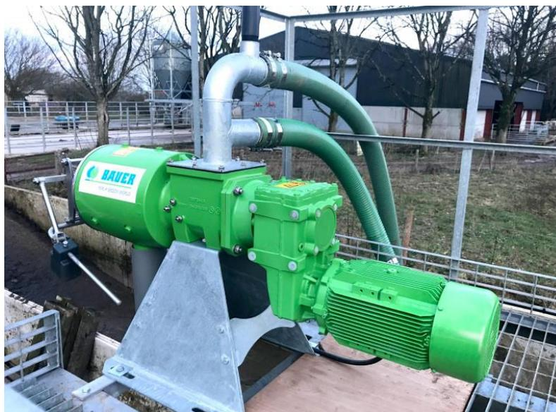
Ilustración 27. Separador BAUER SEPARATORS300. Fuente: Bauer página web
