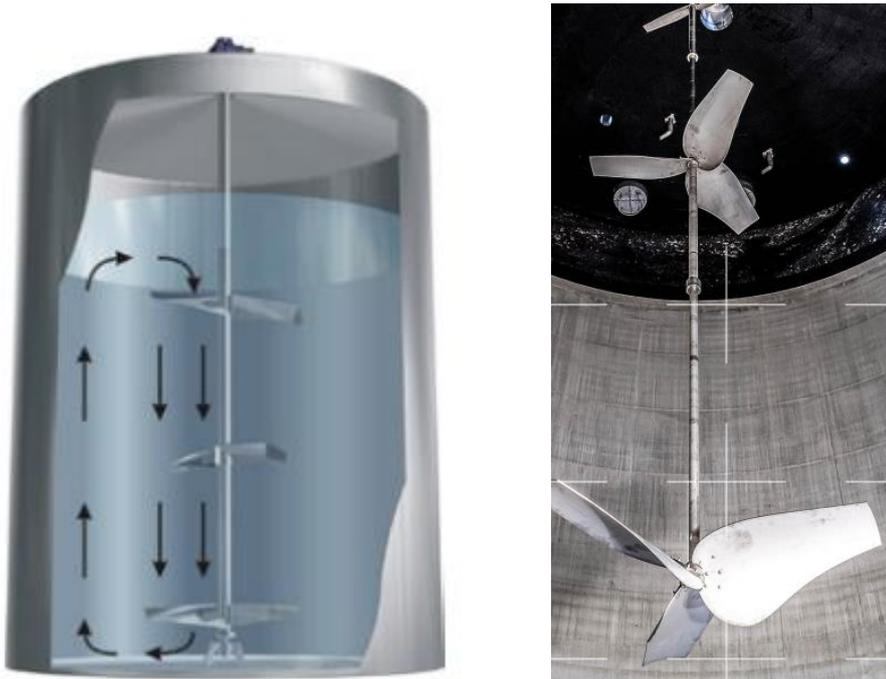
Ilustración 12 Agitadores axiales verticales. Fuente: SULZER
