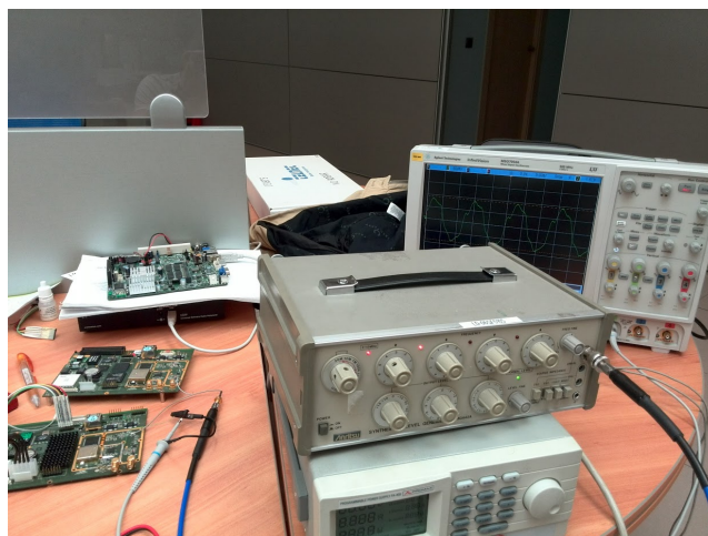
FIGURA 3.2: Escenario de trabajo para prototipado del ADC y downlink compuesto de una fuente de alimentación un generador de frecuencias, un osciloscopio y la placa de desarrollo Microhemir.
