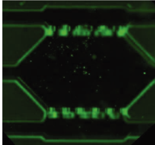
FIGURA 13: PÉRDIDA POR SEDIMENTACIÓN CELULAR DEBIDO A LA LENTA VELOCIDAD DE INYECCIÓN. Se sembró una densidad celular inicial de 3 millones de células/ml, dado que el volumen interno de la microcámara es de 0.3 \mu l, deberían verse alrededor de 900 células.
