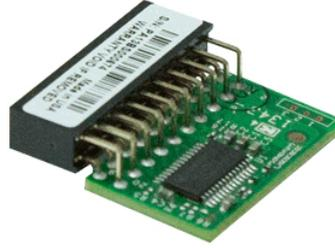
Figura 2.1: Trusted Platform Module listo para ser conectado en una placa madre
