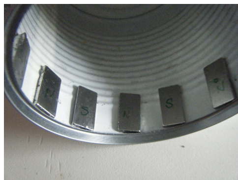
Figura 7.2 Mecanización lata (figura izquierda); Figura 7.3 Imanes dentro de la lata (figura derecha)
