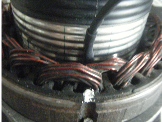
Figura 12.1: Sensor Hall: Parte blanca del estator es el diente donde se apoya sensor
