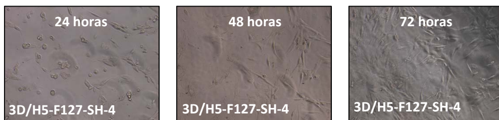
Figura 4.18. Imágenes en contraste de fases para ensayos 3D de hidrogeles al 5% (w/v) de F127-SH-4 tras 24, 48 y 72 horas de ensayo.
