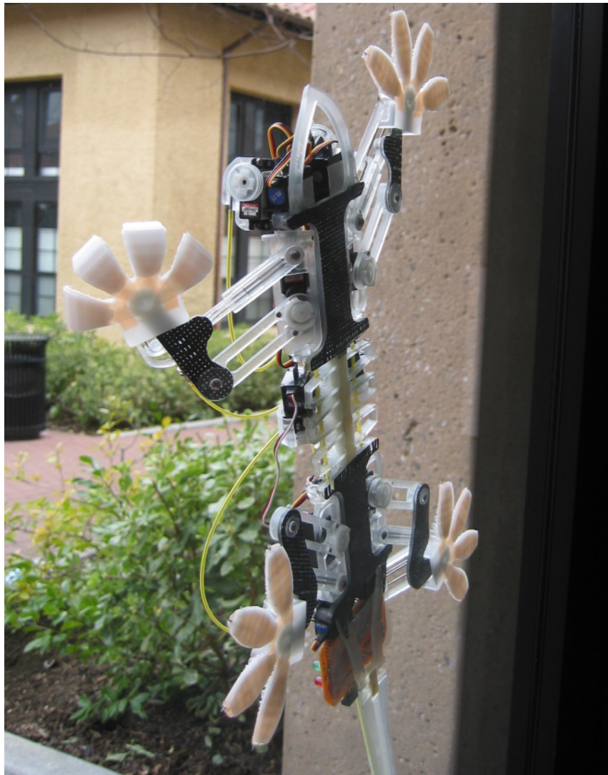
Figura 2.27: Stickybot basado en el gecko y sus habilidades, Universidad de Stanford.
