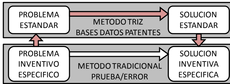
Figura 2.22: Esquema simplificado del proceso TRIZ.
