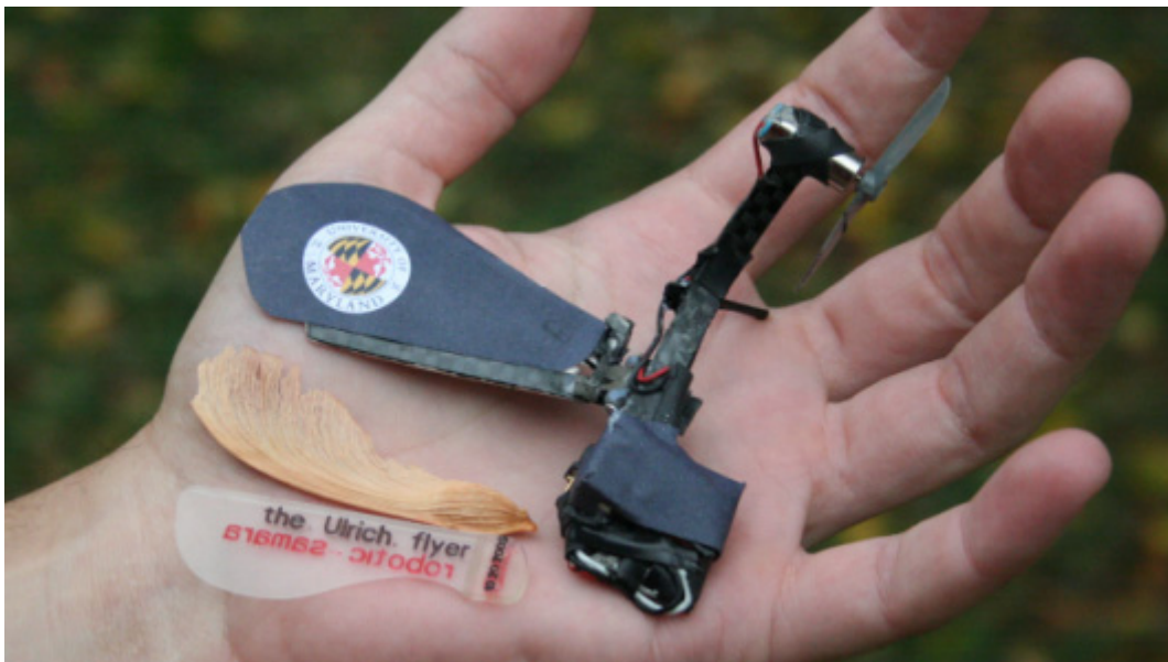
Figura 5.6: Semilla de Samara y prototipo de monoptero. (Imágenes: Evan Ulrich/A. James Clark School of Engineering, Universidad de Maryland).
