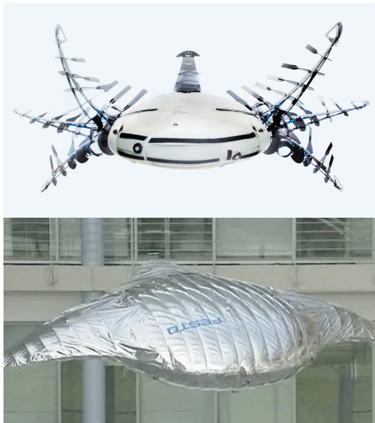
Figura 2.10: Robot manta, aplicaciones submarina y aérea.
