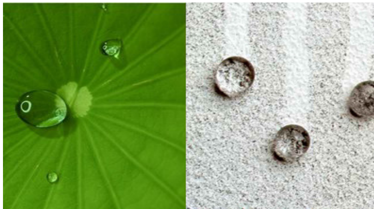
Figura 2.6: Imagen de hoja de loto y aplicación de Lotusan sobre paredes.
