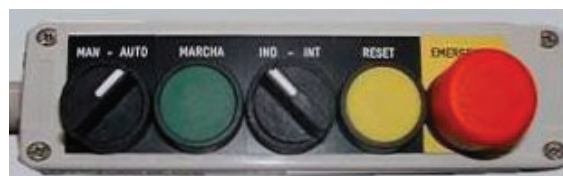
Figura 4.11: Botonera física de la estación de transporte. Se aprecian los diferentes pulsadores y selectores a los que se hace referencia.
