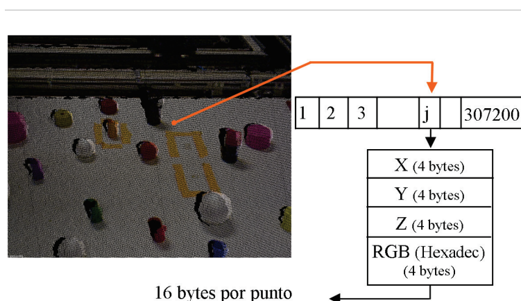
Figura 6.4: Esquema explicativo del almacenamiento de información en formato «Nube de Puntos».
