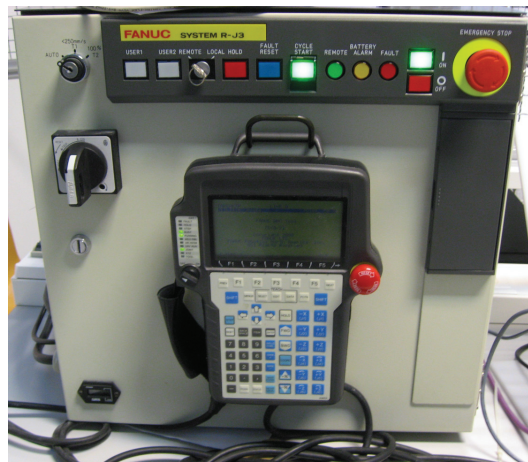
Figura 3.1: Armario del controlador RJ-3 del robot FANUC, con el terminal de enseñanza en primer plano.
