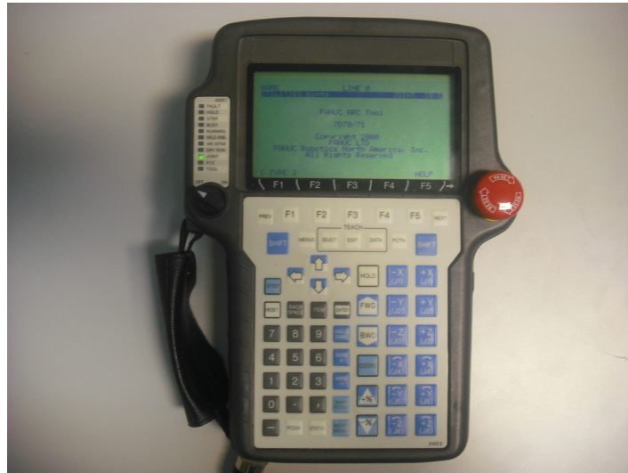
Figura 3.2: Terminal de enseñanza del robot FANUC. Se aprecia el pulsador de emergencia.
