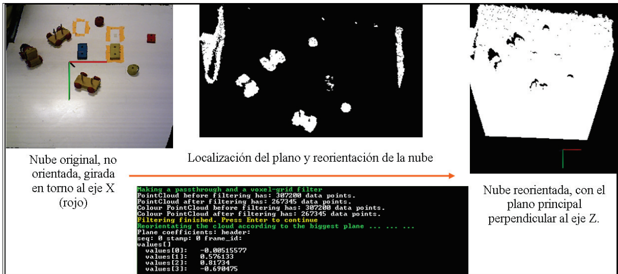
Figura 6.7: Proceso seguido para reorientar una nube de puntos.
