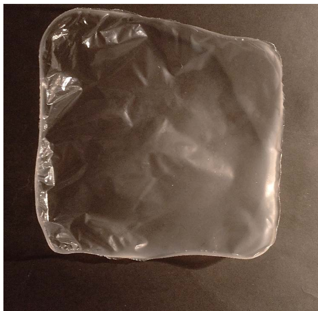
Figura 2.5. Film de CMC-POM-LAE 5 %.
