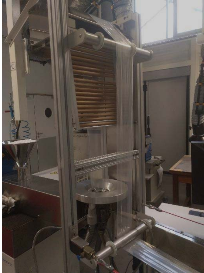
Figura 2.13. Proceso de extrusión por soplado de los films de PLA-POM-LAE 5 %. La burbuja que se forma se hace pasar por unos rodillos que permiten alisarla y obtener la bolsa que posteriormente se corta para obtener el film.
