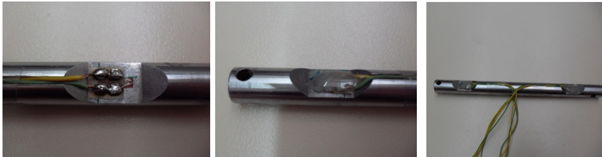
Fotos 4,5, y 6: Eje del expulsor con las galgas y las conexiones protegidas con la resina
