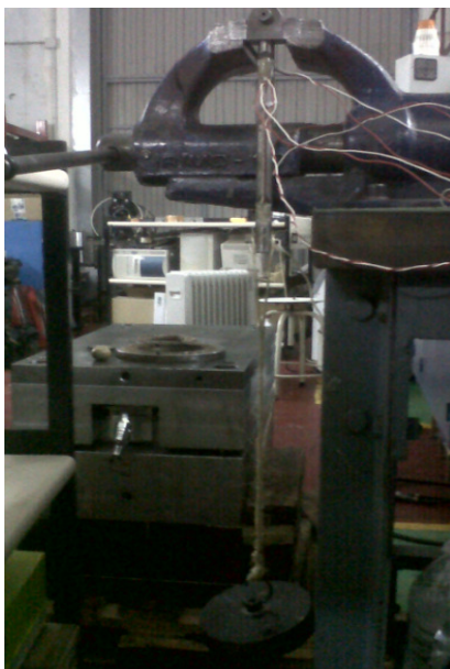
Foto 8: Calibración de las galgas en vertical
