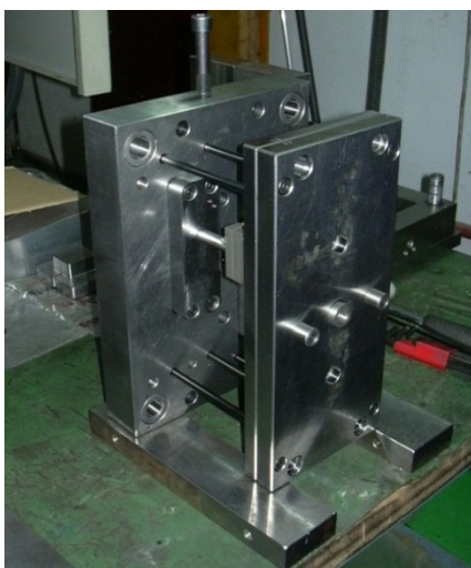
Foto 21: Montaje placas expulsión
