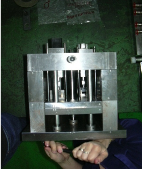
Foto 22: Montaje placas fija
