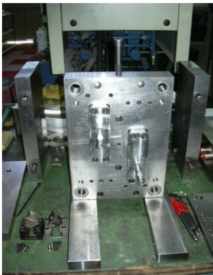
Fotos 16: Montaje expulsor y cabezal
