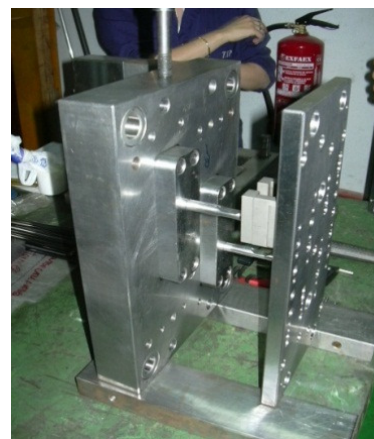
Foto 18: Fijación del cocu a la placa expulsora fina
