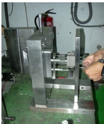
Foto 18: Fijación del cocu a la placa expulsora fina
