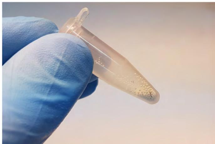
Figura 33: Tubo de eppendorf de 1,5 mL con microesferas de circonio-sílice de 0,5 mm de diámetro tras la agitación con vórtex durante diez minutos. Obsérvese que las patas han permanecido intactas con este método de fragmentación. Fuente: aportación propia.
