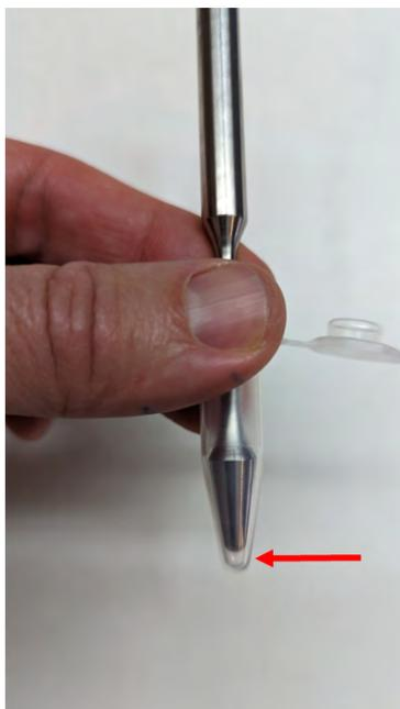
Figura 36: Micropistilo de acero inoxidable dentro de un tubo eppendorf de 1.5 mL. Obsérvese que la punta del micropistilo no llega a hacer contacto con el fondo del tubo eppendorf (flecha roja). Esto puede dificultar el contacto entre el micropistilo y las patas, haciendo que el proceso de fragmentación sea más laborioso y, posiblemente, menos eficiente
