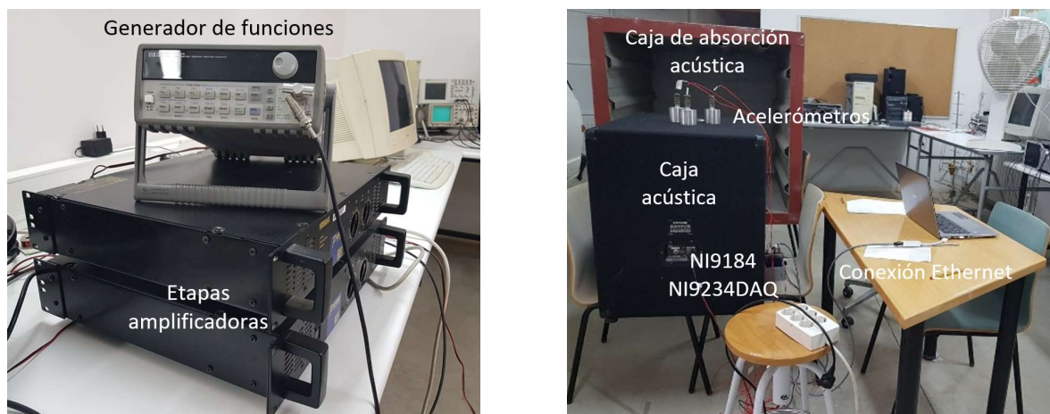
Figura 4.4. Imagen del generador de ondas y amplificador e imagen del sistema del equipamiento de producción de vibraciones controladas.
