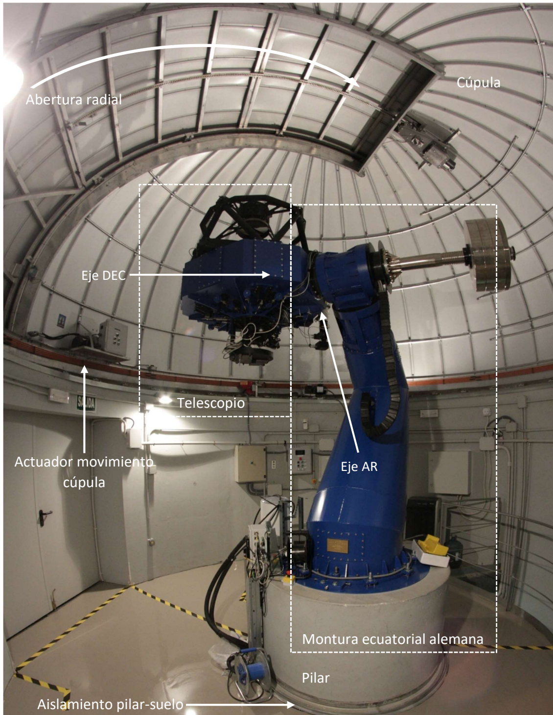
Figura 3.8. Telescopio JAST80, cúpula y pilar. Descripción de la estructura y movimientos.
