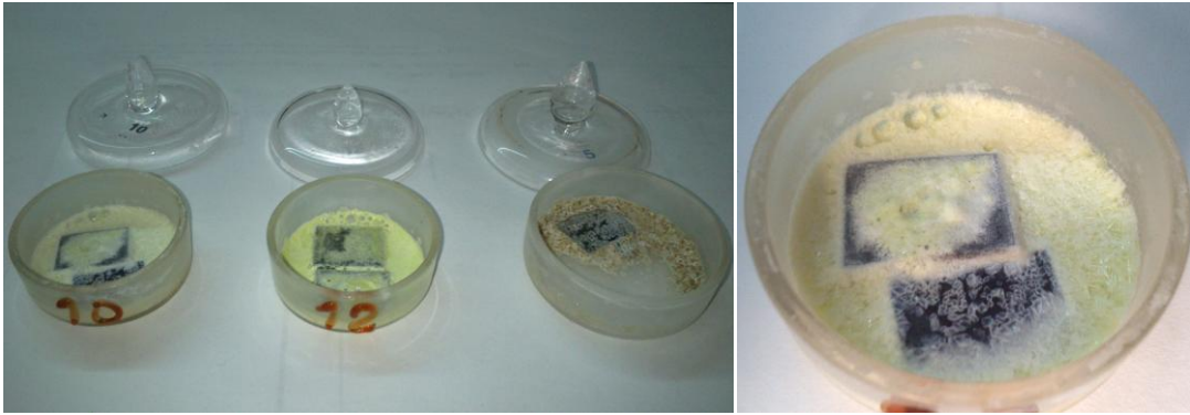
Figura 9: Aspecto de los metales tras su tratamiento en horno con K_2S_2O_7 .
