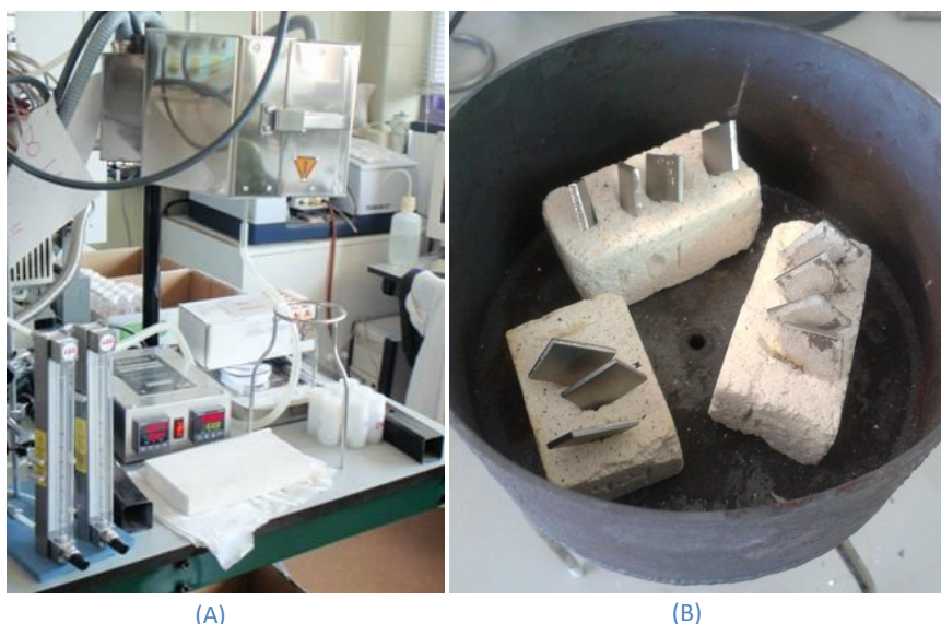
Figura 5: (A) Instalación de horno utilizada para los tratamientos. (B) Disposición de los cupones metálicos en los portamuestras dentro del horno.
