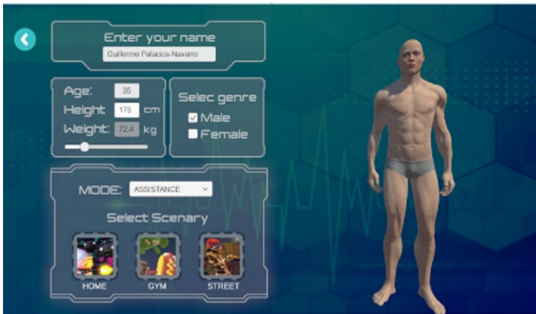
Figura 4.11. Simulador virtual de rutinas de movimiento predefinidas. La interfaz virtual permite seleccionar y caracterizar el tipo de avatar a considerar en la simulación. También permite seleccionar el entorno virtual para la animación 3D.
