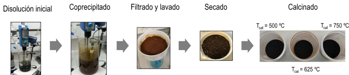
Figura 3.5. Diferentes imágenes del catalizador Ni/Al 3 Fe 1 durante su síntesis.
