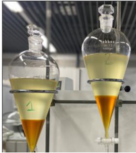
Figura 3.11. Imagen del proceso de separación biodiésel y glicerol crudo. La fase superior es biodiésel y la fase inferior es glicerol crudo.
