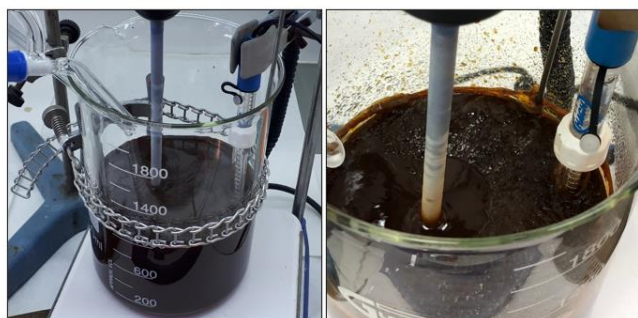
Figura 3.4. Imagen de la disolución gelatinosa formada durante la síntesis de los catalizadores Ni/Al-Fe.
