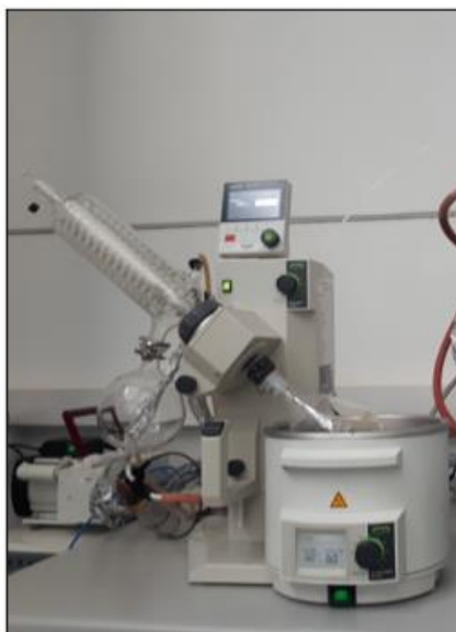
Figura 3.13. Imagen de la etapa de eliminación del exceso de metanol y trazas de agua.
