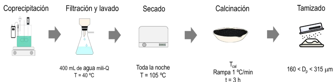
Figura 3.2. Esquema del procedimiento de síntesis de los catalizadores Ni/Al.
