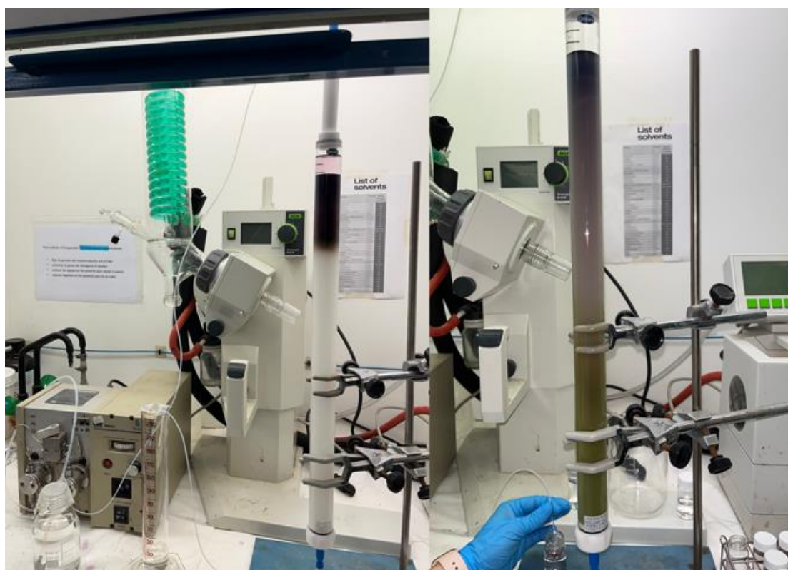
Fig.4.2. Sistema cromatográfico empleado para el fraccionamiento con sílica. En el lado izquierdo se muestra el sistema a poco de comenzar el análisis y en la derecha transcurrido un tiempo.
