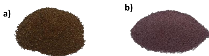
Figura 4.26. Imágenes del transportador fresco (a) y después de 38 h de gasificación (b).
