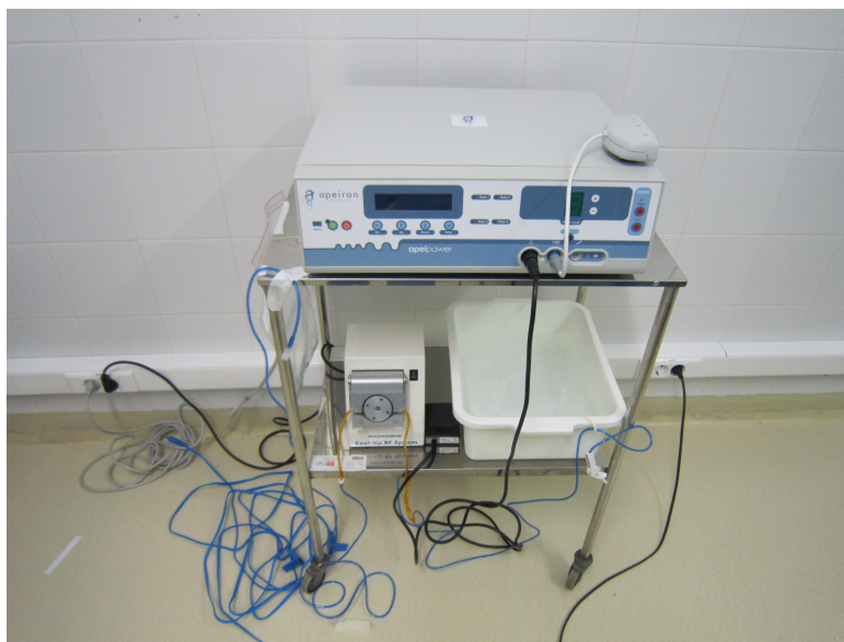
Figura 45: Conexiones de la fuente de radiofrecuencia y la bomba peristáltica.
