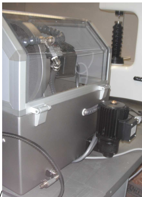
FIGURA 18: Parte frontal de la máquina: Metallographic Cut-Off Machine TR100E.
