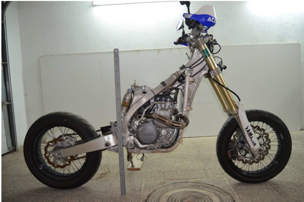
Imagen 4. En proceso de desmontaje para el estudio de la geometría del chasis
