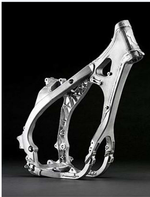
Imagen 8. Chasis original en aluminio
