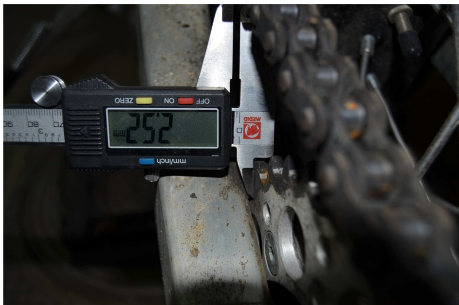
Imagen 5. La holgura entre corona dentada y basculante es finalmente de 2.5 mm
