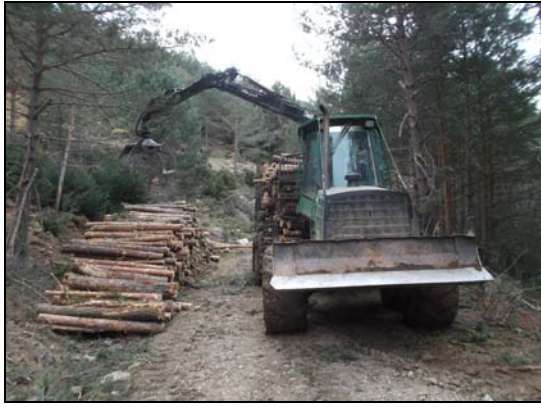
Figura 16: Autocargador en funcionamiento. Aprovechamientos forestales en el CS de La Solana de Burgasé. Fuente: Elaboración propia
